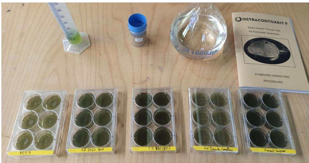
**En haut:** Dispositif expérimental de mise en contact des organismes avec le sédiment.
