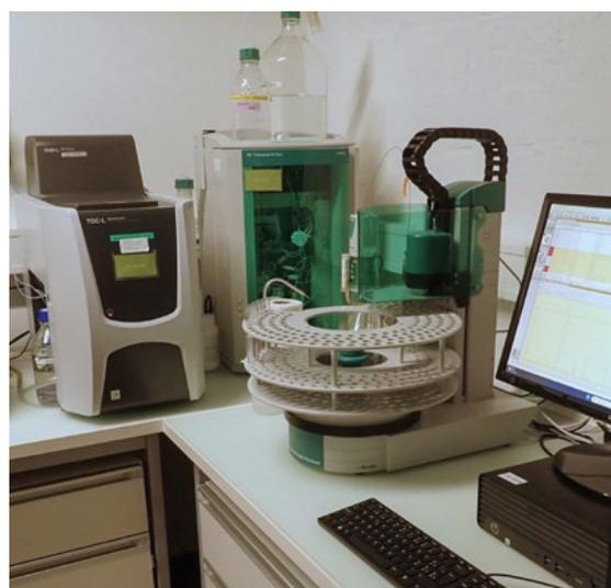
Après réception des échantillons numérotés de façon unique pour assurer la traçabilité, ceux-ci sont préparés et filtrés pour des analyses effectuées sur plusieurs instruments (ici : analyseur du carbone et chromatographie ionique pour le chlorure).
