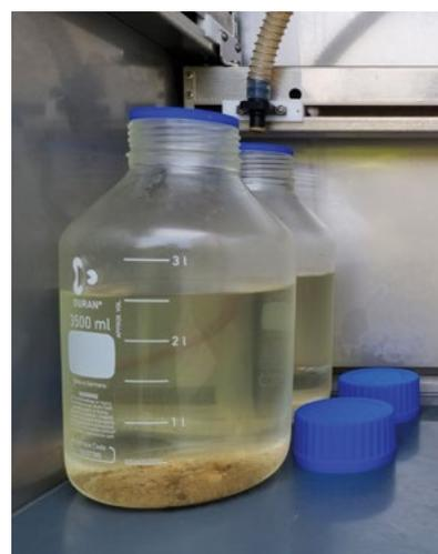
Le prélèvement des échantillons pour la détermination des micropolluants nécessite des armoires de prélèvement réfrigérées qui gèrent des prises d'aliqots d'eau de la rivière régulièrement pendant 14 jours. Ceci nécessite donc des flacons en verre de grande capacité.
