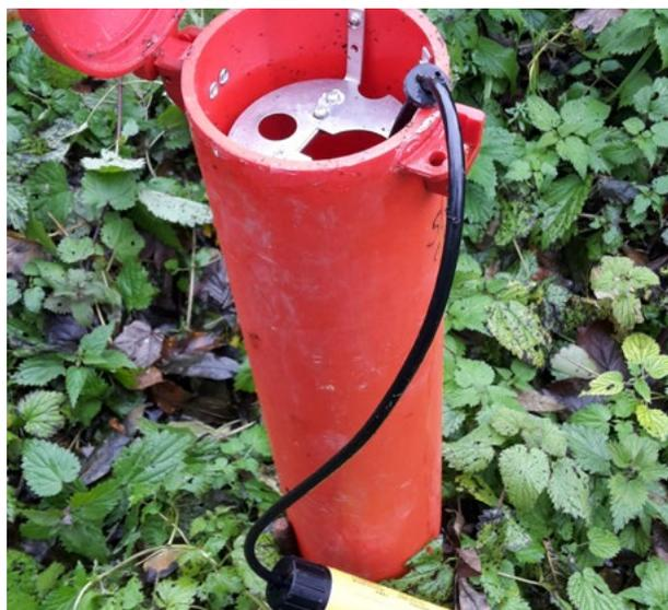
Exemples de sites de surveillance des eaux souterraines : un piézomètre (Bex).
