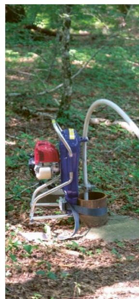
Bois de Chêne, prélèvement au fond du piézomètre à l'aide d'une pompe.
