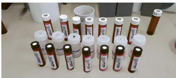
Arrivés au laboratoire, les échantillons sont préparés pour être analysés sur différents instruments. Ici une chromatographie gazeuse (analyse des COV) et liquide (analyses des pesticides et des traceurs des eaux usées) associées à des spectrométries de masse.
