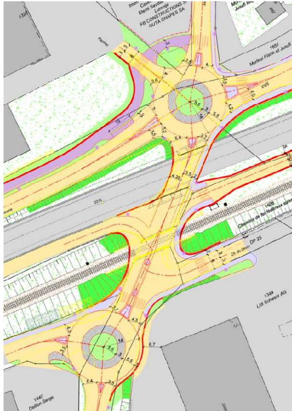
Figure 7 : Les deux giratoires ainsi que les trois ouvrages (Pont des Sorbiers 601, PI CFF, Rampe)
