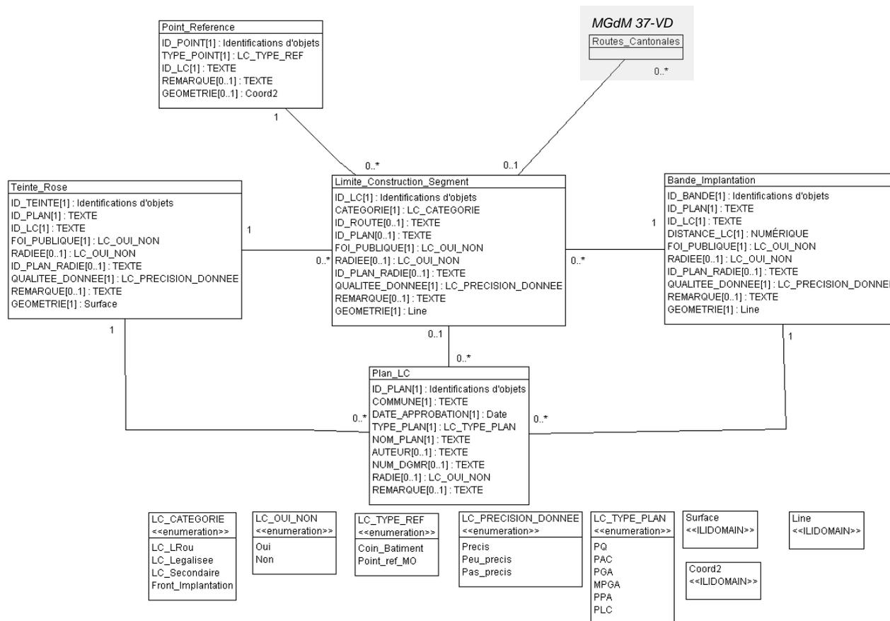
Figure 1 : Diagramme de classes UML pour les limites des constructions des routes communales et des routes cantonales hors traversée de localité.
