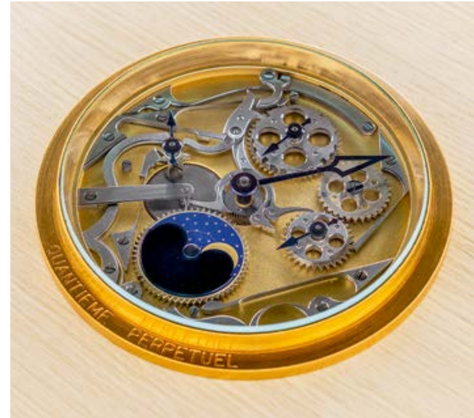
I11.24 Modèle de démonstration d'un Quantième perpétuel, collection École Technique de la Vallée de Joux.
