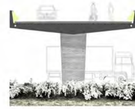
Figure 1.13 - Section de la structure porte-à-faux
