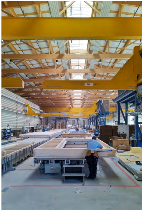
préfabrication des ossatures bois dans les ateliers de Renggli SA
