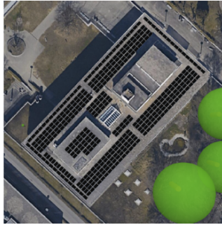
Vue aérienne avec calepinage photovoltaïque
